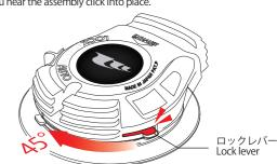
5) ロックレバーが下り、確実にロックされているか確認してください。 5. Make sure that the lock lever is down and securely locked.
